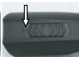
Kuva 5 Kytin ON-asennossa ("I")
